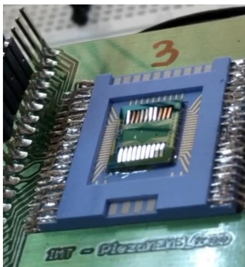
Fig. 7 Structura PiezoMEMS în timpul măsurătorilor
