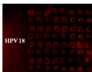
(a) Rezultatul hibridizării pe nanofire funcționalizate cu GOPTMS
