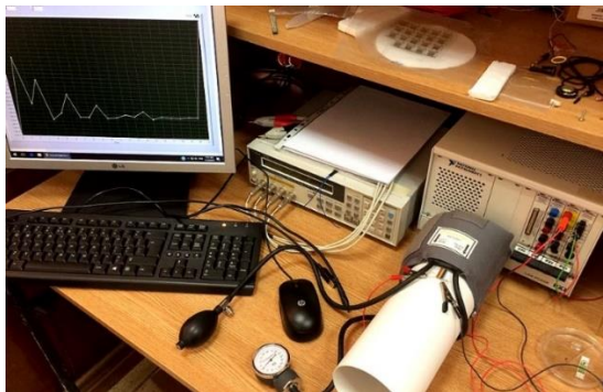
Fig. 13 Sistemul de măsură pentru evaluarea funcționalității senzorului
