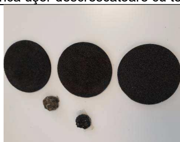
Elemente de izolare termică bazate pe aerogeluri din grafenă pentru automobilul Dacia Renault
